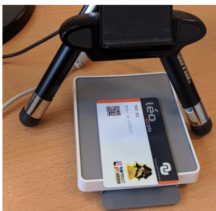
Figure 7 - Dispositif d'encodage des cartes, comprenant webcam et encodeur
