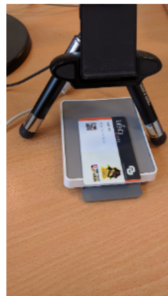
Lecteur NFC et Webcam pour encodage de carte en s'aidant du QR Code EPPN ou ESCR
