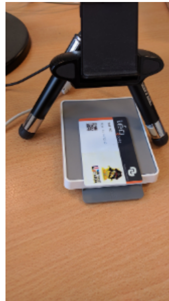
Lecteur NFC et Webcam pour encodage de carte en s'aidant du QR Code EPPN ou ESCR
