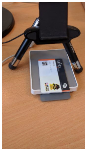
Lecteur NFC et Webcam pour encodage de carte en s'aidant du QR Code EPPN ou ESCR
